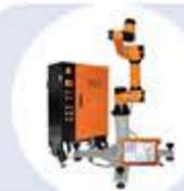
**傲博轻量型机械臂**：高品质、低成本的工业机器人。完全基于模块化理念研发设计，可根据需求自由配置成4-7个自由度。紧凑精巧的机械设计，轻量化，高精度，易于安装部署和编程
