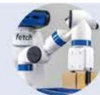
**Fetch**：7个自由度的手臂，带有扩展安装点的机体以及可拆卸的夹持器组成，在科学研究、智能家居以及服务业等方面都有着广泛的应用。内置开源ROS操作系统提供强大的应用开发平台
