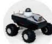
**Summit-XL轻量型移动平台**：拥有四个电机轮，每个轮子都含有包括变速箱和编码器的无刷电机。能够适用于各种室内外任务支持通用型的ROS操作系统，可轻易地实现定位、地图绘制等
