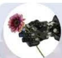
**Shadow灵巧手**：24个自由度的灵活程度，前臂区域包含了全驱动系统（空气肌肉和阀组或电动机）。整合了所有必要的控制系统（基于GNU GPL提供的软件），以及研究和教学方面的文件
