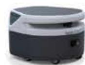
**Freight**：机体带有扩展安装点能够比较容易的与其他设备集成，内置ROS开源操作系统，使其更容易进行科研和二次开发。最大行走速度为2m/s，其内部可安装导航，手柄操纵等应用
